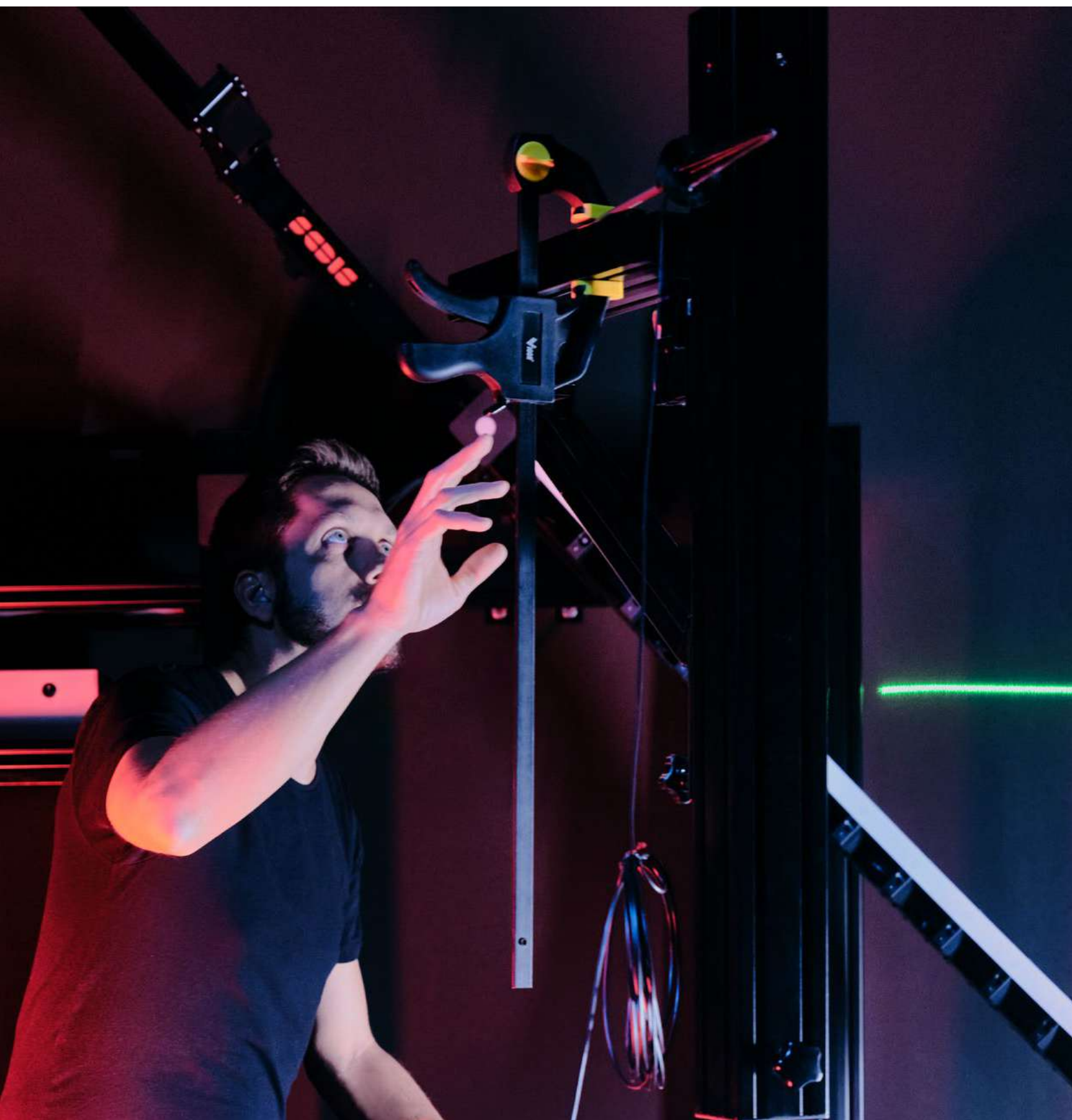
↑ Configuring the goniophotometer Impostazione del goniofotometro
