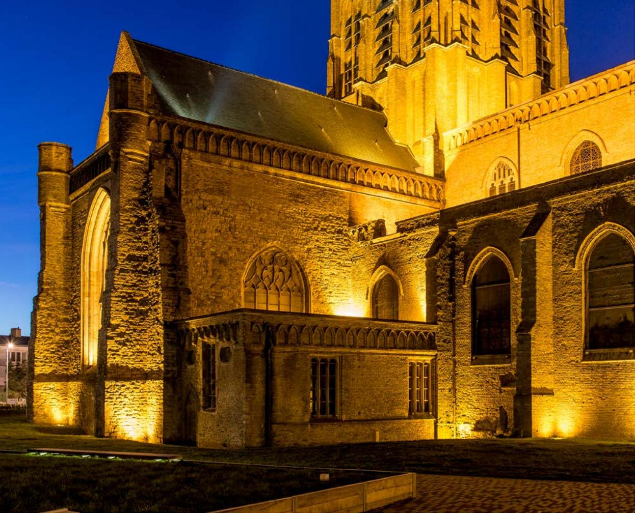
Die überrollbaren, korrosions- und feuchtigkeitsbeständigen Bodeneinbauleuchten Medio und Atlantique beleuchten die monumentalen Fassaden und die übergehenden Profil-Bodeneinbauleuchten Mini Corniche erhellen die Randbereiche des Bauwerks. Die Scheinwerfer
