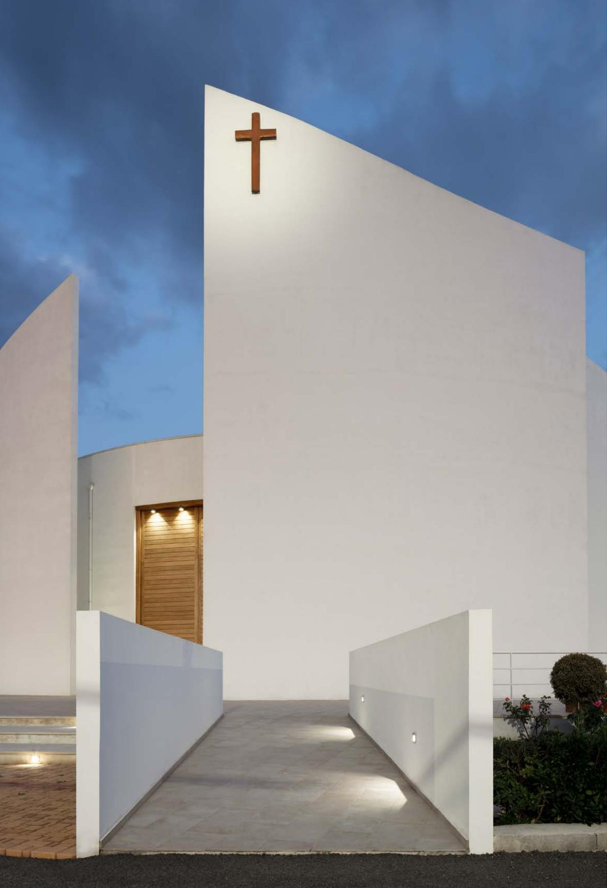
Pour profiter au maximum de l'espace, le choix s'est porté sur les spots encastrés au sol Mini adaptés au passage des véhicules, avec source LED 10 W (3000 K, lumière chaude) et filtre elliptique, évitant ainsi d'éblouir les gens qui passent tout en garantissant un effet lumineux correct. Les projecteurs One,
