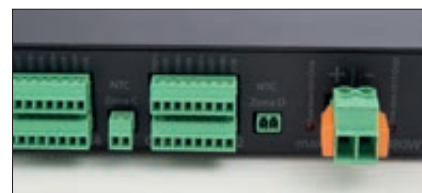
Collegamenti Morsettiera di cablaggio ad innesto rapido.
